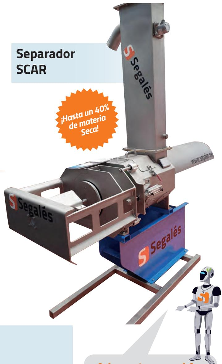
Equipos con un intervalo de separación de entre 6 m<sup>3</sup>/h y 80 m<sup>3</sup>/h
