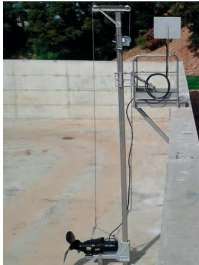
**SOPORTE PARA DEPÓSITOS ABIERTOS DE PARED VERTICAL**
