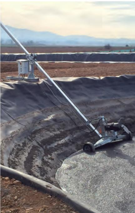
**SOPORTE CON RUEDAS "JET" PARA BALSAS CON TALUD**
