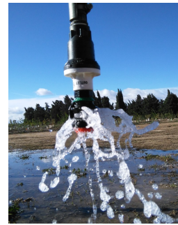
Boquilla de baja presión instalada en pivot - Pruebas de diseño
